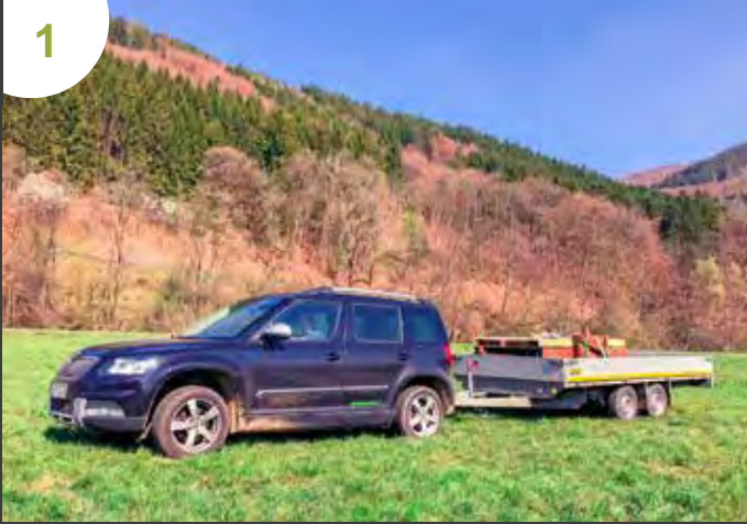
1 Förster-Kanzel mit Unterbau 2,35 m, Gitterrostpodest mit Geländer und Erdankerschrauben auf einem Pkw-Anhänger.
